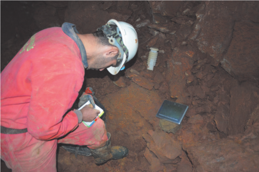
Fotoğraf 149. Mağara içinin sıcaklık, bağıl nem ve basınç değerleri ölçülmüştür. Photo 149. Temperature, relative humidity and pressure values of the cave were measured.
