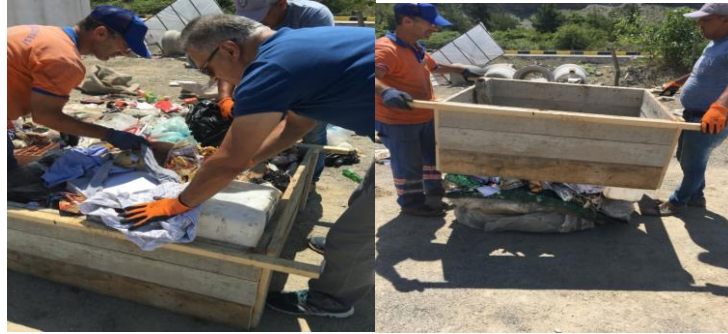
Şekil 2-21. Sabit hacim kabının doldurulması ve boşaltılması
