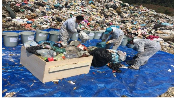
Şekil 2-2. Sabit hacim kabının doldurulması
