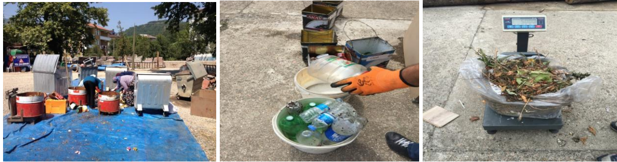
Şekil 2-22. Bileşen kaplarının doldurulması ve atıkların ayrıştırılarak tartılması
