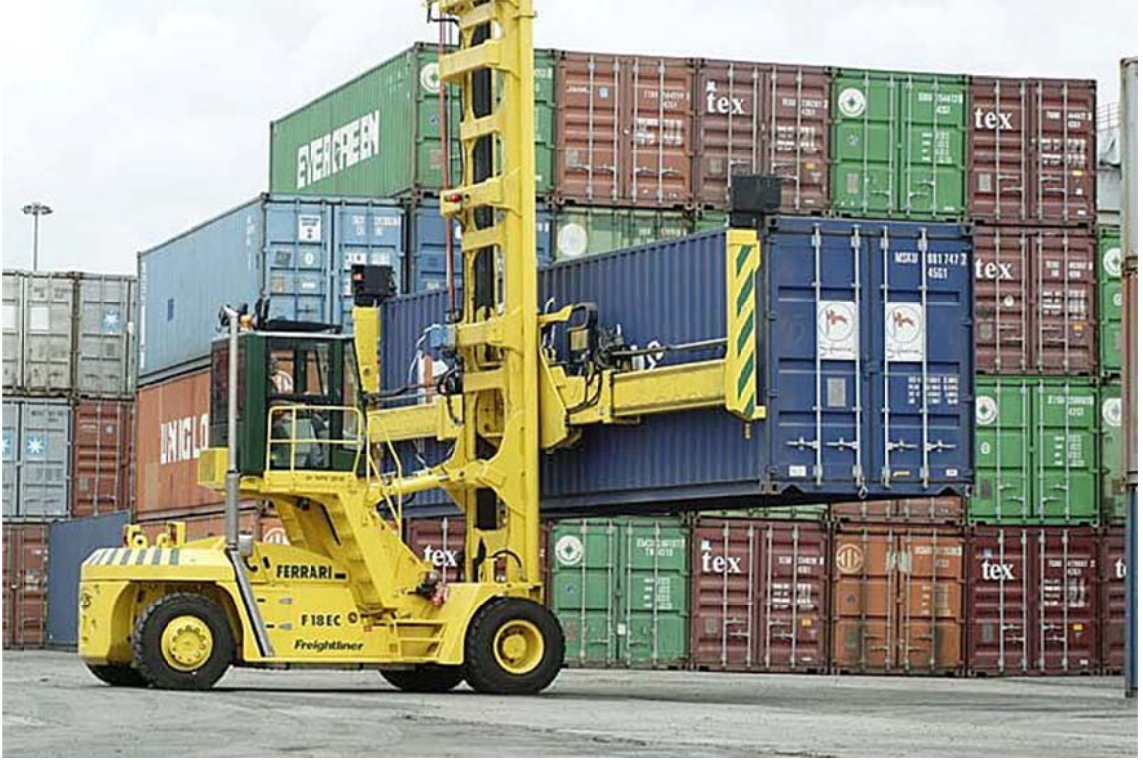
Şekil 3.9. ECS (Empty Container Stacker)
