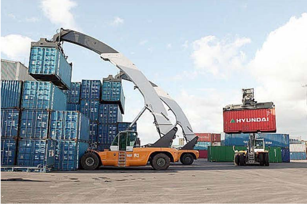
Şekil 3.7. CRS (Container Reach Stacker)
